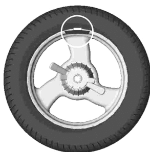
Рисунок 6.6 - Груз установлен в «12 часов»
