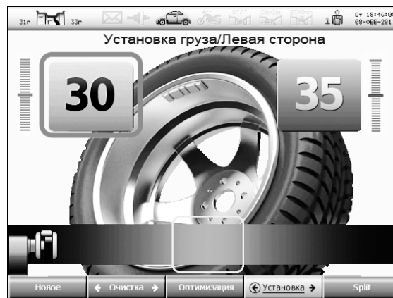
Рисунок 5.12 – Экран при установке груза линейкой
