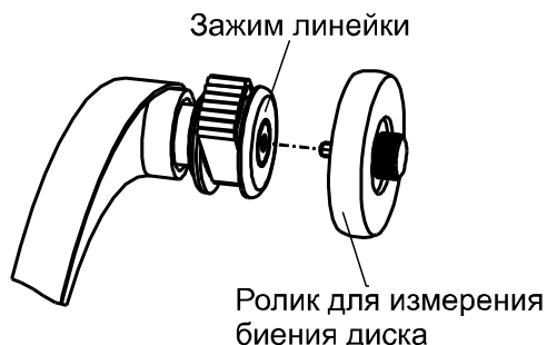
Рисунок 7.5 – Ролик для измерения биений
