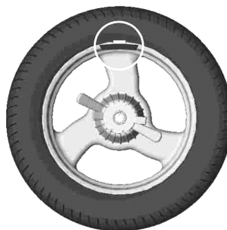
б - груз установлен в положение «12 часов»
